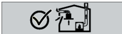
Fig. 2: Risco de envenenamento
