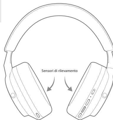
Diagramma 3 Ubicazione del sensore di rilevamento
