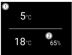
Fig. 23 Status-Anzeige* (1) Temperatur (2) Luftfeuchtigkeit
