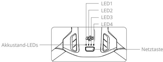
Die Akkustand-LEDs zeigen den Ladestand des Akkus während des Auf- und Entladens an. Die LED-Status werden nachstehend beschrieben:
