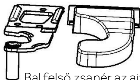
Bal felső zsanér az ajtó megfordíthatóságához
