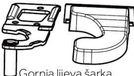
Gornja lijeva šarka za reverzibilnost vrata
