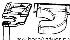
Ľavý horný záves pre otočenie dverí
