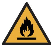
Danger; risque d'incendie/ matières inflammables
