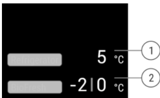
Fig. 8 The status display shows the actual temperature.*
