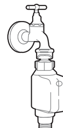
tuyau d'alimentation de sécurité
