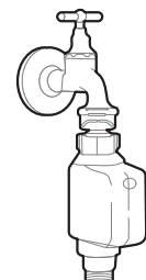
tuyau d'alimentation de sécurité
