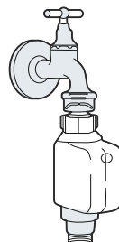
tuyau d'alimentation de sécurité
