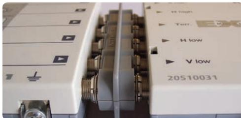
En el caso de equipos separados unos de otros se recomienda la utilización de cables coaxiales de alta calidad (con valores de apantallamiento muy elevados), p. ej. LCD 111. Si es posible utilice conectores F de alta calidad para el *Engarzado a presión* (imagen derecha) o como conector de compresión (véase el catálogo Kathrein *Instalaciones de antena de satélite y de recepción terrestres*).
