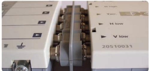
Bei weiter voneinander entfernten Geräten empfiehlt sich die Verwendung von hochwertigen Koaxialkabeln (mit sehr hohen Schirmungswerten), z. B. LCD 111. Verwenden Sie nach Möglichkeit hochwertige F-Stecker zum *Crimpen* (Bild rechts) oder als Kompressionsstecker (siehe Kathrein-Katalog *Satelliten- und terrestrische Empfangs-Antennenanlagen*).
