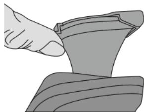
1. Retire la unidad de corte de la afeitadora si está colocada. El cabezal de corte debe agarrarse por los dos lados y retirarse con fuerza.
