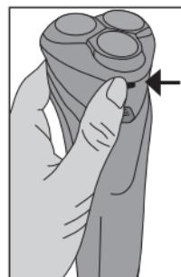
3. Halten Sie die Scherköpfe so unter fließendes Wasser, dass der Wasserstrahl von innen nach außen durch die Scherköpfe fließt.
