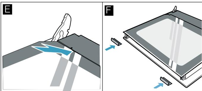
7. Die Abdeckung aufsetzen und anschrauben.
