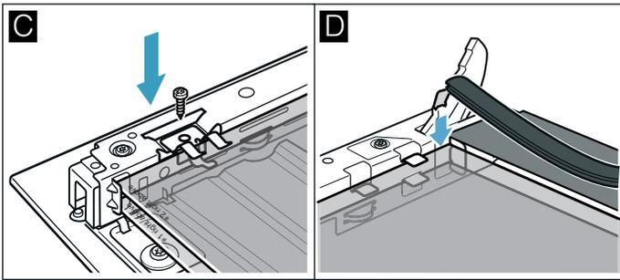
5. Die oberste Scheibe an den beiden Halterungen festhalten und schräg nach hinten einschieben. Darauf achten, dass die Dichtung nicht nach hinten rutscht (Bild E).
