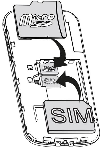
Die Kontakte der SIM-Karte dürfen nicht zerkratzt oder verbogen werden. Wenn Sie die SIM-Karte entfernen/austauschen müssen und Probleme beim Entfernen/Einlegen haben, kleben Sie ein Stück Klebeband auf den freiliegenden Teil der Karte und ziehen Sie sie damit heraus.
